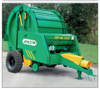
Пресс-подборщик рулонный безременной ПР-Ф-180 с постоянной камерой прессования предназначен для подбора и прессования в рулоны валков сена естественных и сеяных трав, соломы с последующей обмоткой рулона шпагатом. Подача шпагата осуществляется с помощью электропривода. Пресс-подборщики предназначены для применения во всех зонах земледелия, кроме горных районов.
