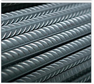
Прокат арматурный свариваемый периодического профиля класса A500C для армирования железобетонных конструкций по ГОСТ Р 52544-2006 и СТО АСЧМ 7-93 диам. 10–40 мм предназначен для армирования железобетонных конструкций, применяемых в промышленном и гражданском строительстве.
