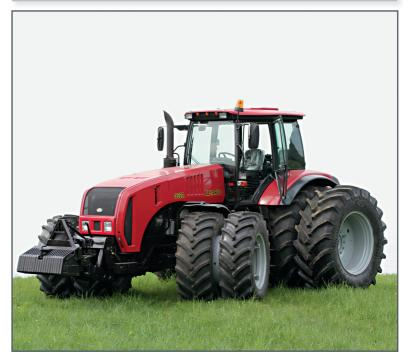
Трактор предназначен для выполнения энергоемких сельскохозяйственных работ в составе широкозахватных и комбинированных агрегатов на основной и предпосевной обработке почвы, посеве зерновых и других культур, заготовке кормов, уборке зерновых и технических культур; для выполнения транспортных работ, стационарных работ, в строительстве и промышленности. Двигатель: дизель «Дойтц» TCD2013 L064V C3UT261 с турбонаддувом и промежуточным охлаждением надувочного воздуха (261 кВт), Stage 3A.
