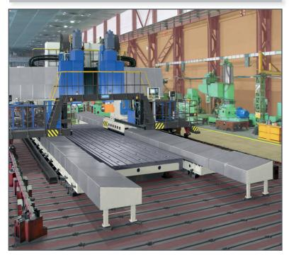
Станки портальные продольные фрезерно-расточные с шириной обработки от 1000 до 2500 мм предназначены для комплексной обработки крупногабаритных корпусных, базовых и других деталей методом фрезерования, растачивания и сверления. Станки оснащены устройствами ЧПУ, цифровой индикации и автоматического переезда рабочих органов по преднабору. Высокая эксплуатационная жесткость станков позволяет вести производительную черновую и точную чистовую обработку корпусных деталей из стали, чугуна и сплавов.
