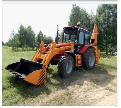
АМКОДОР 702ЕМ-03 выполняет земляные и погрузочно-разгрузочные работы в стесненных условиях, перевозку сыпучих и штучных грунтов на короткие расстояния. В состав машины входят погрузочное оборудование с двухчелюстным ковшом и экскаваторное оборудование с гидравлическим поперечным перемещением. Угол атаки ножа позволяет срезать дерновое покрытие и производить планировку. С помощью челюстного ковша выполняются захват и погрузка бревен, армированного строительного мусора.
