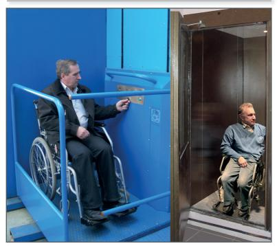
Платформы подъемные с вертикальным перемещением для инвалидов (открытого и закрытого типа) устанавливаются в зданиях для удобства людей с ограниченными возможностями передвижения. Имеют консольное расположение грузонесущей платформы относительно направляющих (типа «Рюкзак»). Грузонесущая платформа состоит из каркаса. Монтаж электрооборудования выполнен в панели управления. Контроль загрузки осуществляется аппаратом обнаружения наличия пассажира, контроль перегрузки – взвешивающим устройством.
