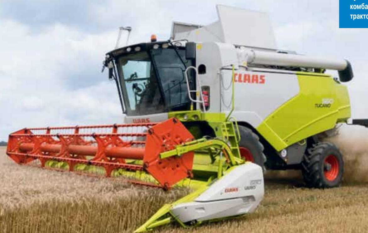
площадь сепарации к разным условиям уборки и достичь тем самым максимальной пропускной способности. Зерновой бункер был увеличен до 9000 л, который при повышенной нагрузке, до 105 л/с, производительности может быть разгружен всего за две минуты.
