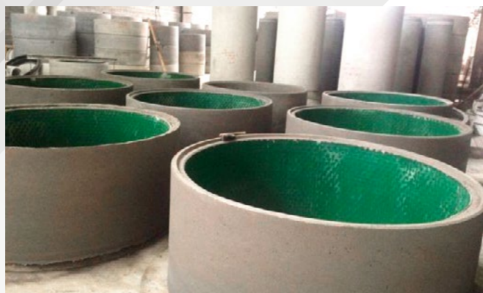
ФУТЕРОВАННЫЕ ЖЕЛЕЗОБЕТОННЫЕ КОЛЬЦА
