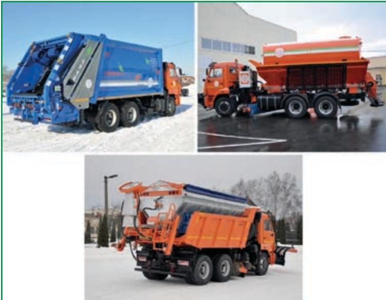
**МУСОРОВОЗЫ С ЗАДНЕЙ ЗАГРУЗКОЙ: МК-4546-08, МК-4545-06, МАШИНА ДЛЯ СОДЕРЖАНИЯ ДОРОГ СО СМЕННЫМ ОБОРУДОВАНИЕМ МК-4533-08, МК-4534-08 НА БАЗЕ САМОСВАЛА**
