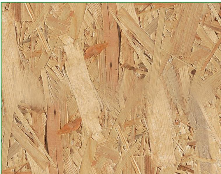
**ПЛИТЫ ДРЕВЕСНЫЕ С ОРИЕНТИРОВАННОЙ СТРУЖКОЙ (ОСП, OSB) «КАЛЕВАЛА-ЭКОДОМ»**
