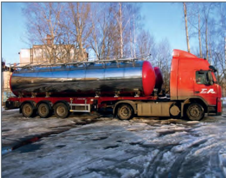
**ПОЛУПРИЦЕП-ЦИСТЕРНА ДЛЯ ПЕРЕВОЗКИ ПИЩЕВЫХ ЖИДКОСТЕЙ С СИСТЕМОЙ АВТОНОМНОГО ПОДОГРЕВА ЯДИШ-ВМ-ППЦ(4X2)-PS24P-27,5/3-80-РП. МОДЕЛЬ 912811**
