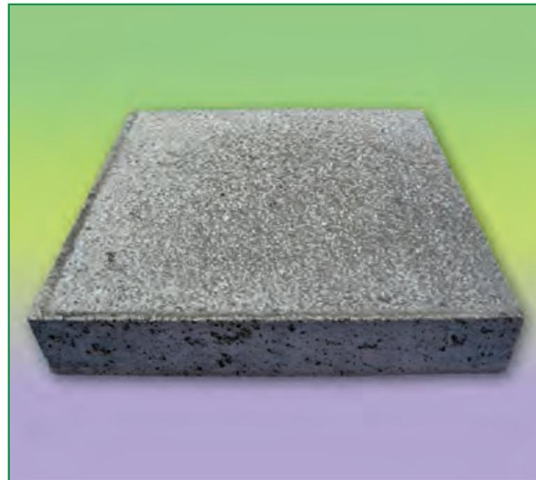
Изделия из полистиролбетона – высокоэффективные конструктивно-теплоизоляционные материалы с плотностью от 200 до 500 кг/м<sup>3</sup>, прочностью от 2 до 20 кгс/см<sup>2</sup> применяются для несущих и самонесущих наружных стен зданий, утепления перекрытий и покрытий.
