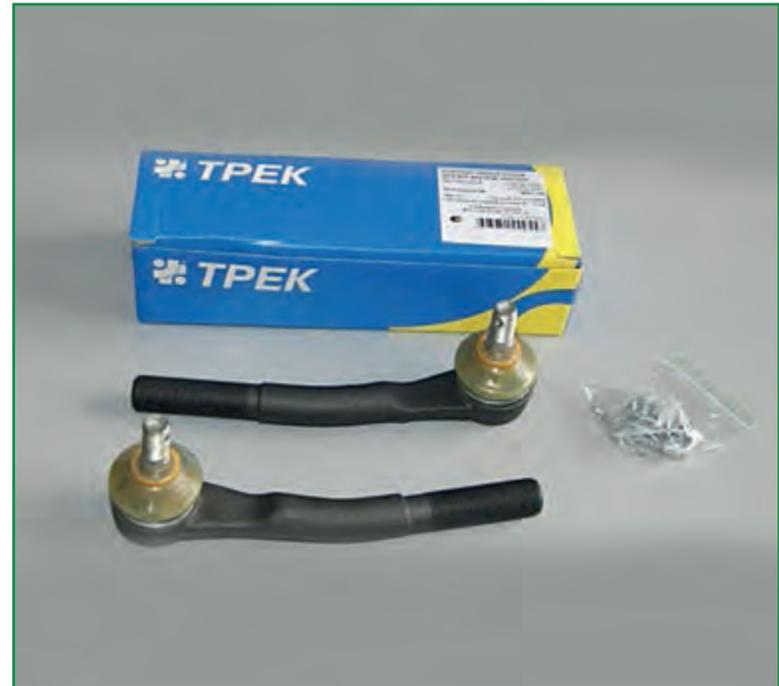
Наконечники тяги рулевой трапеции наружные серии «Чемпион» рекомендованы для автомобилей ВАЗ 2108-21099 и ВАЗ 2113-2115. Особенностью конструкции является отсутствие пружины, что положительно сказывается на управляемости автомобиля особенно при езде по неровным дорогам. Защитный колпачок из полиуретана обладает большей прочностью, морозо- и износостойкостью по сравнению с резиновым. Корпус наконечников цельнокованный, что полностью исключает вероятность выдавливания шарового пальца.
