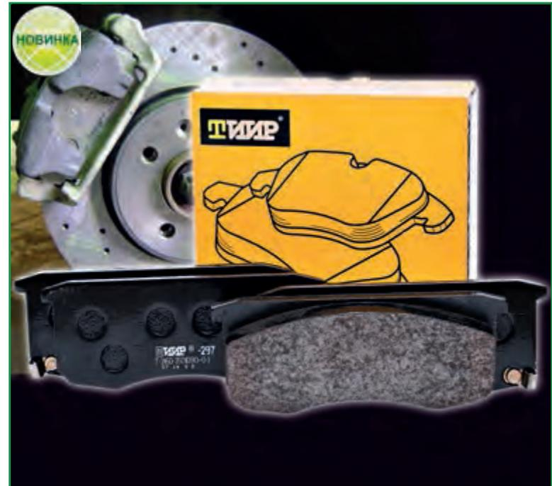
Изготавливаются из композита ТИИР-297 с улучшенными потребительскими свойствами и с повышенными на 15–20% характеристиками по эффективности торможения. Изделия выпускаются с механическим акустическим индикатором износа, сертифицированы в составе автомобиля в испытательном центре ФГУП «НАМИ» (Москва). С апреля 2014 г. поставляются для комплектации конвейера ОАО «УАЗ». Изделия соответствуют современным требованиям по экологической и функциональной безопасности.
