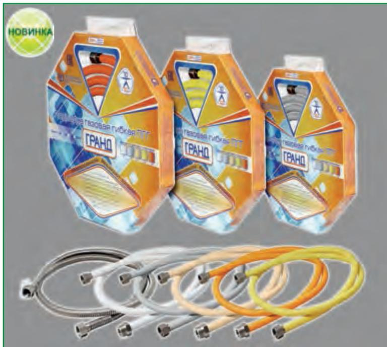
Подводка газовая гибкая ПГГ «Гранд» предназначена для присоединения коммунально-бытовых газовых приборов, отопительных котлов и другого газового оборудования, работающего на природном газе по ГОСТ 5542-87 или на сжиженном газе по ГОСТ 20448-90 и ГОСТ Р 52087-2003. Изготовлена полностью из первоклассной нержавеющей стали по ГОСТ 5632-72. Прочная и гибкая при эксплуатации, проходит 100%-ный контроль качества. Сделана в России. Срок службы – 50 лет.
