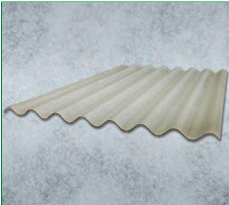
Лист хризотилцементный волнистый профиля 40/150 уменьшенной толщины выпускается на высокотехнологичном автоматизированном оборудовании австрийской фирмы «Фойт». Предназначен для устройства кровель и стеновых ограждений зданий и сооружений жилых, общественных, сельскохозяйственных и производственных зданий и сооружений. Размеры листа: 1750×1130×5,2 (мм), восемь волн. Продукция прошла полное освидетельствование в АНО «Красноярскстройсертификация». Самый удобный и надежный кровельный материал.
