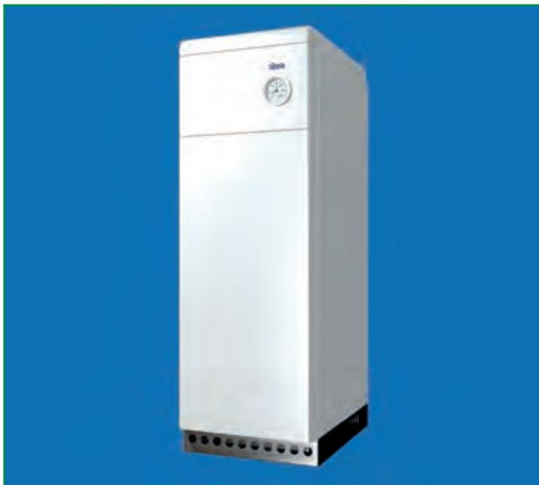
Аппарат отопительный газовый бытовой АОГВК-11,6-3 Ростов модель 2210-022 исп. 3 Siberia 11K – типовой представитель моделей 2210, 2210K. Предназначен для отопления помещений площадью до 125 м<sup>2</sup> и горячего водоснабжения с расходом воды 3,8 л/мин. Аппарат оснащен автоматикой Eurosit (Италия), газогорелочным устройством с горелкой Polidoro, термометром, пьезорозжигом. Аппарат компактен, имеет современный дизайн. Используемое топливо – природный газ.
