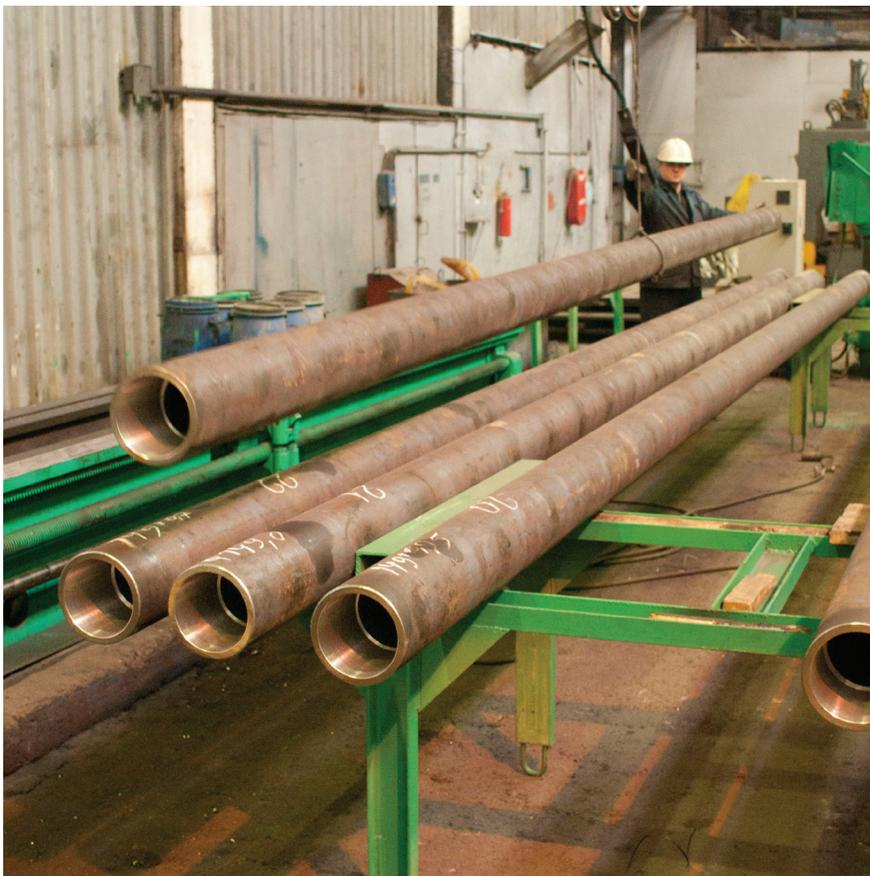
Штанга буровая предназначена для промышленного бурения взрывных скважин вращательным бурением. Используется для буровой установки DM45.
