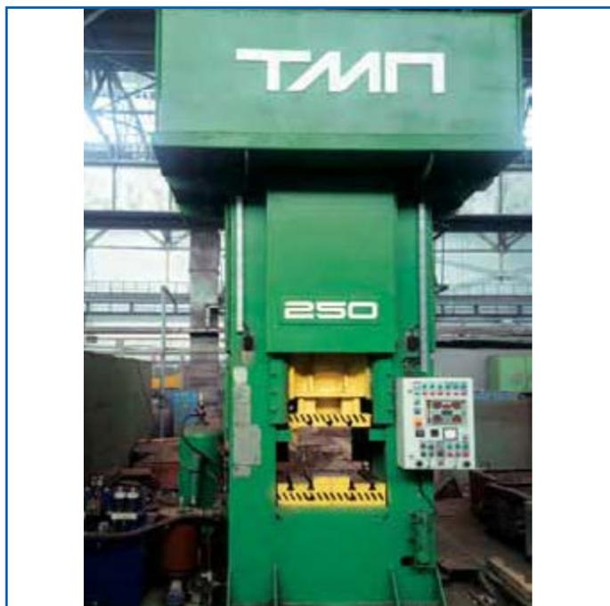
Прессы однокривошипные простого действия усилием 250 тс мод. КЖ9534.03 №6 и КЖ9534.04 №7 предназначены для обрезки поковок в горячем и холодном состоянии, а также для выполнения различных операций листовой штамповки. Применяются во всех отраслях машиностроения. Гарантируется качество изготовления и исправная работа прессов в течение 1 года со дня ввода в эксплуатацию.
